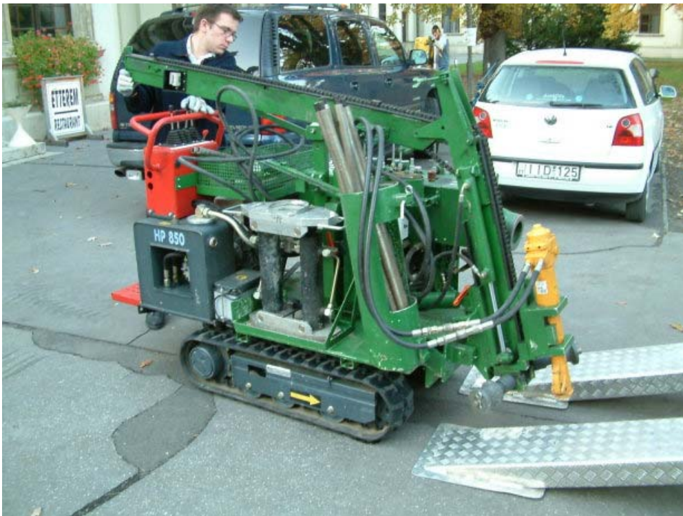
3. ábra: A gép önjárósága a szállításnál és a fúrési pontra állásnál előnyös
