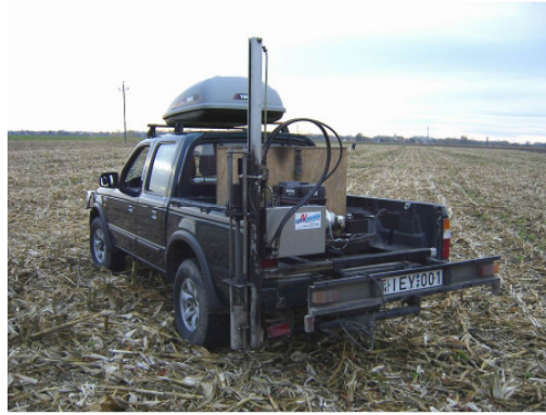
1. ábra: Automata talajmintavevő GPS érzékelővel ellátva
